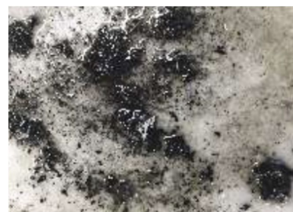
Metaaldeeltjes achtergebleven na het reinigen van een nieuwe ketting.
