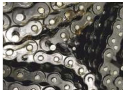
Nieuwe ketting met conserveringsmiddel en vuildeeltjes.
