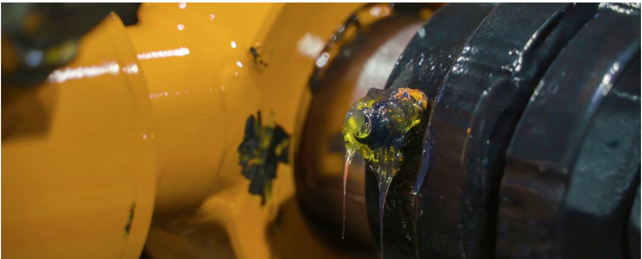
Abbildung 3: Fett tropft aus einem übergeschmierten Lager
