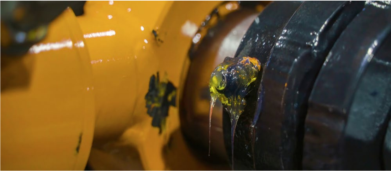
Abbildung 3: Das Fett tropft aus einem übergeschmierten Lager
