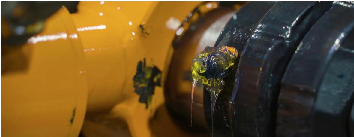
Trafilamento di grasso lubrificante da un cuscinetto con eccesso di lubrificazione
