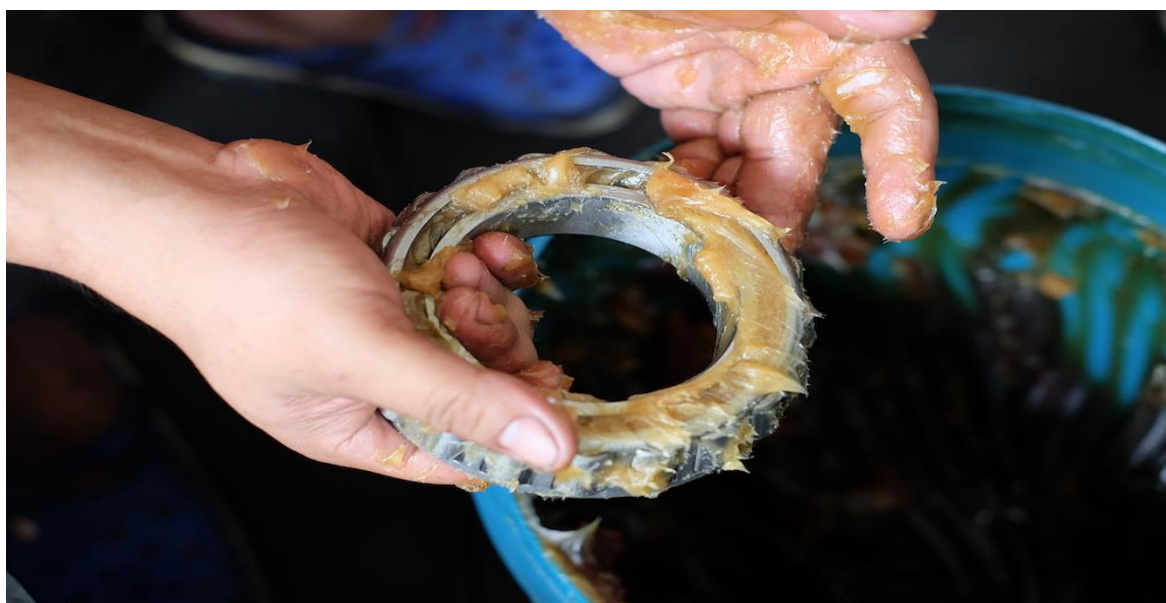
Un cuscinetto con eccesso di lubrificazione
