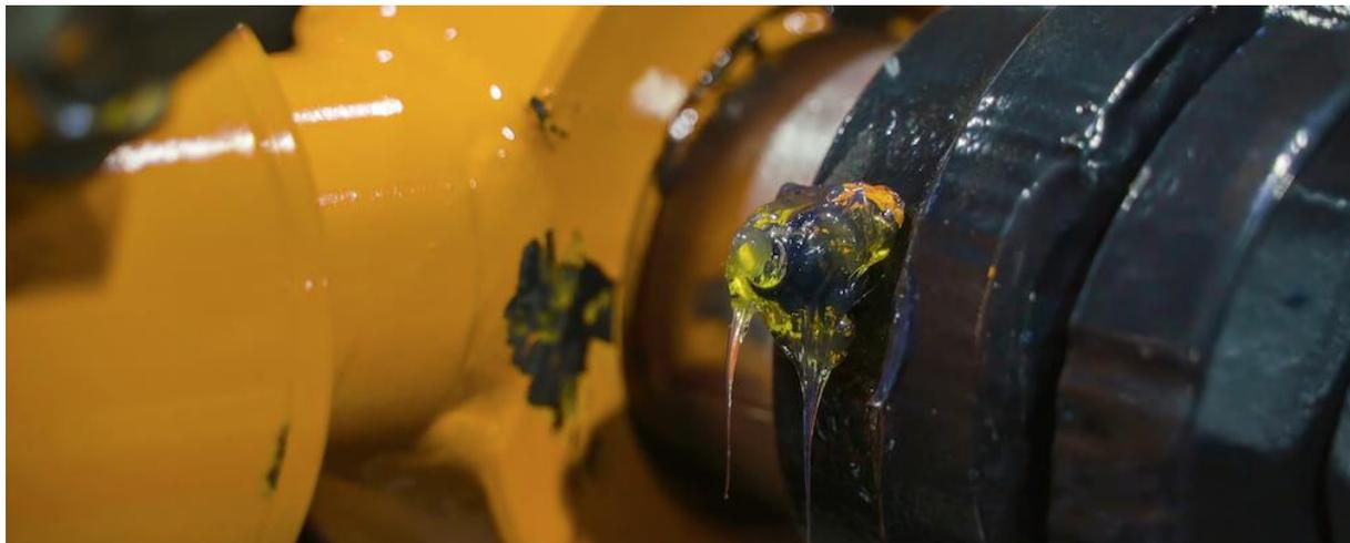
Abbildung 3: Das Fett tropft aus einem übergeschmierten Lager
