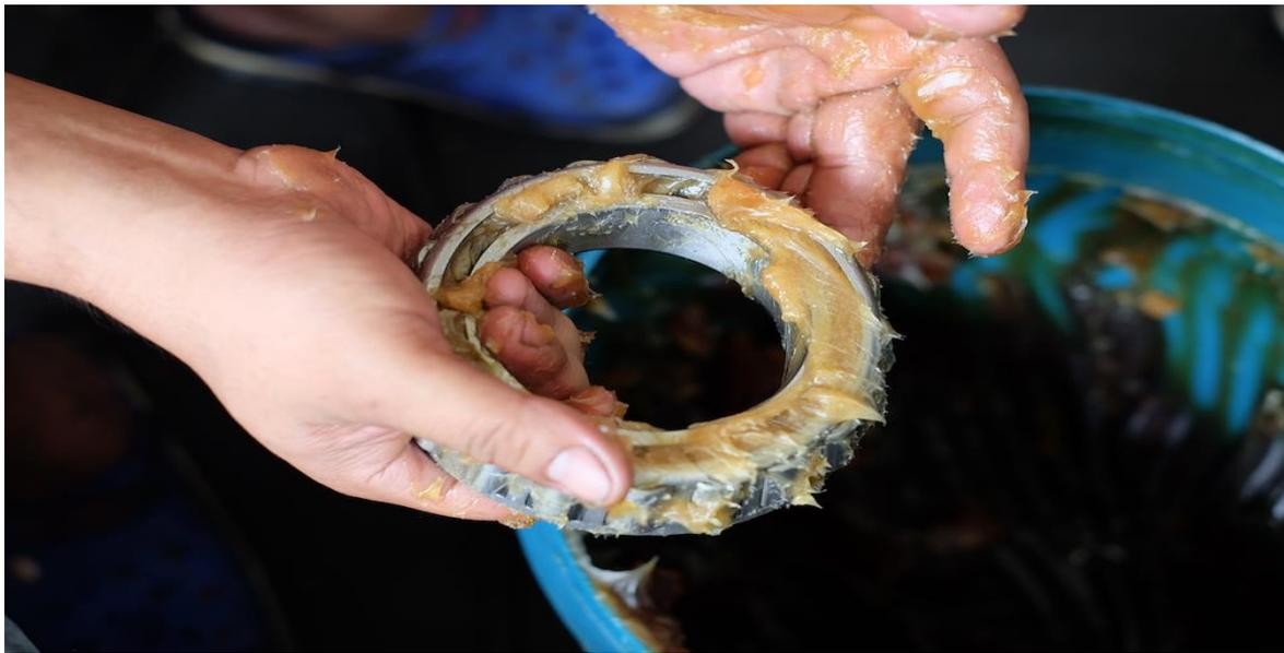
Abbildung 2: Ein überschmiertes Lager
